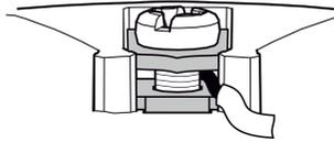
**Рисунок 5.4 – Монтаж провода**
