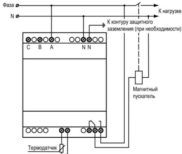
Рисунок 5.3 – Подключение прибора при работе в однофазной сети
