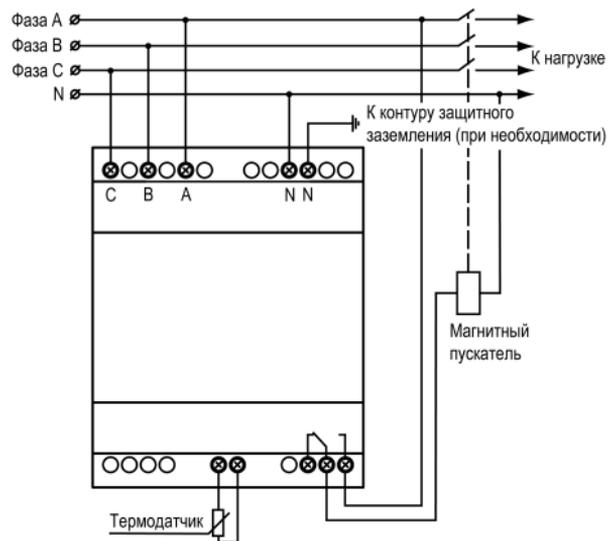
Рисунок 5.2 – Подключение прибора при работе в трехфазной сети
