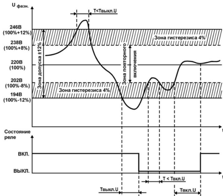
**Рисунок 6.2 – Работа контроля напряжения при установленной зоне допуска  $\pm 12\%$  и гистерезисе 4% от номинального напряжения 220 В**
