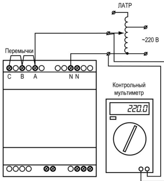
**Рисунок 8.4 – Калибровка канала напряжения**
