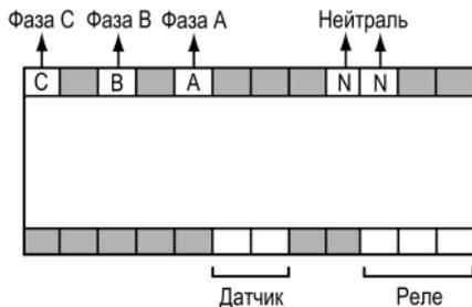
Рисунок 5.1 – Назначение клеммника
