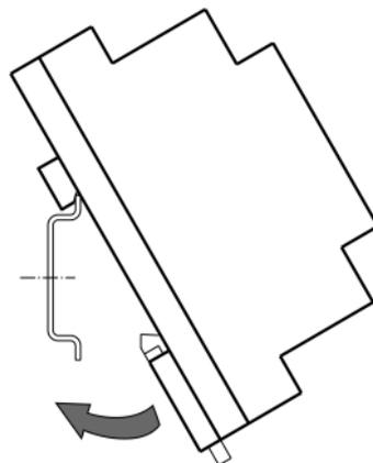
Рисунок 4.1 – Монтаж прибора на DIN-рейку
