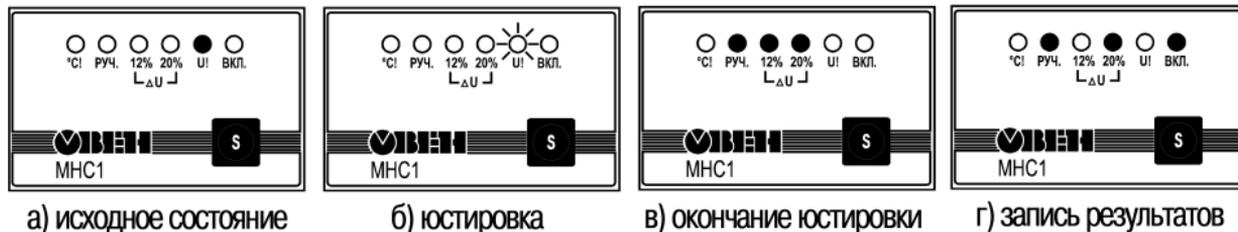
Рисунок 8.5 – Настройка при калибровке
