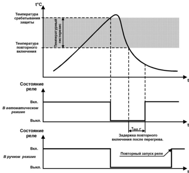
**Рисунок 6.3 – Работа канала контроля температуры объекта**
